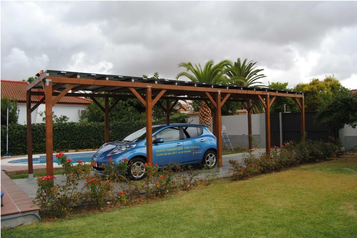
Vista de una pérgola solar en madera con punto de recarga para vehículo eléctrico. La planta solar tiene capacidad para abastecer el 100% de la energía de la vivienda y recargar el coche eléctrico durante la noche.
